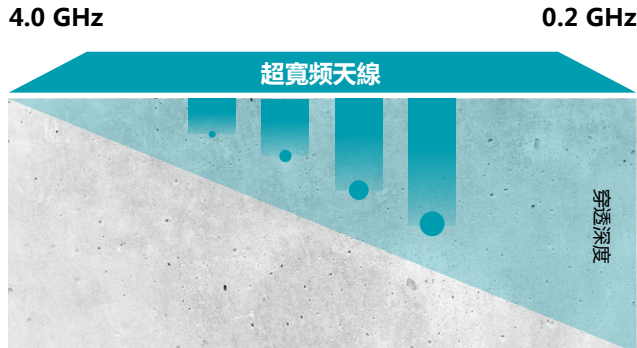
Proceq GPR Live 使用一台設備覆蓋從 0.2 至 4.0 GHz 的所有頻率。較低的頻率允許更大的穿透深度，而調頻允許探測小物體。
